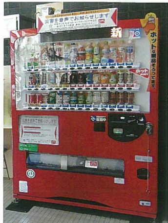
災害警報ユニット内蔵の自動販売機
